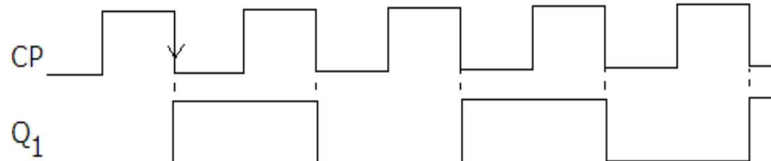
Odrediti frekvenciju izlaznog signala tako spojenih bistabila,ako su početna stanja bistabila  $Q_n=0$ , a frekvencija CP impulsa je 10kHz
