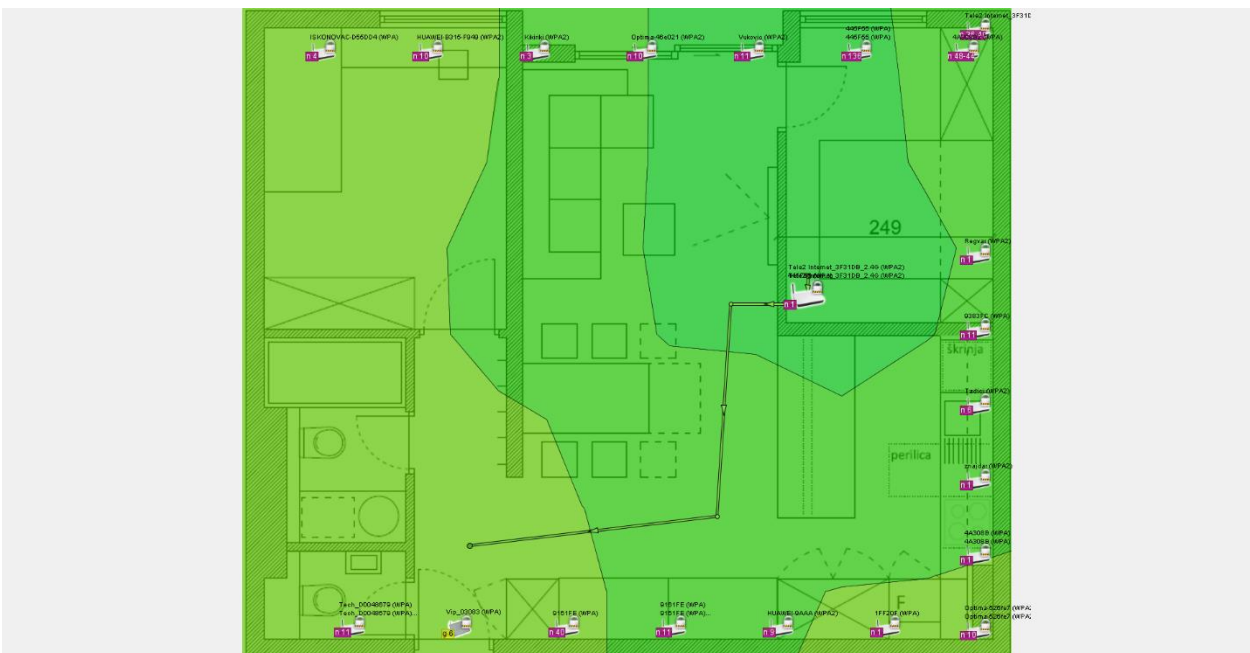
Figure 4 Primjer tlocrta i pokrivenosti signalom kad je AP radio s minimalnom snagom od 13 dBm
